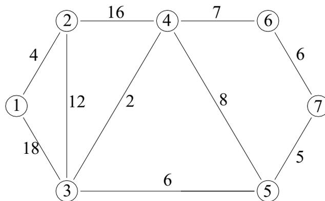
2. 设计如图所示的锅炉房到各座楼铺设暖气管道的路线，使管道总长度最小（单位：m）。
